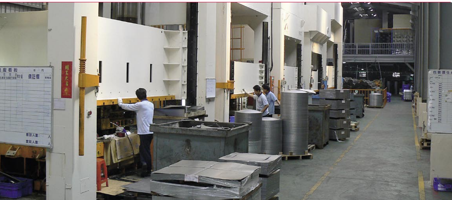
La máquina de prensar: la plancha precortada metálica (en el palet en primer plano) se pone el plato de la prensa de estampación y sale como una antena de desplazamiento.
