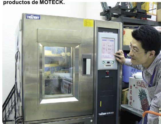
Algunas muestras se separan de la línea de la producción y se prueban en las cámaras medioambientales de frío/calor combinado. Aquí el horno las calienta a 70° C. Las pruebas se realizan de -40° a +90° C.
