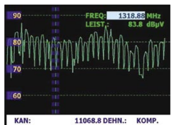
La banda baja horizontal (el LNB convencional a la izquierda y el óptico de Global Invacom a la derecha)!
