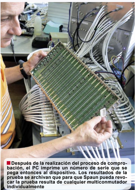
■ Cada multiconmutador se prueba en todas las múltiples funciones. El multiconmutador se inserta en esta estación de la prueba y moviendo una sola palanca se insertan todos los conectores "F" y el proceso de prueba puede empezarse
