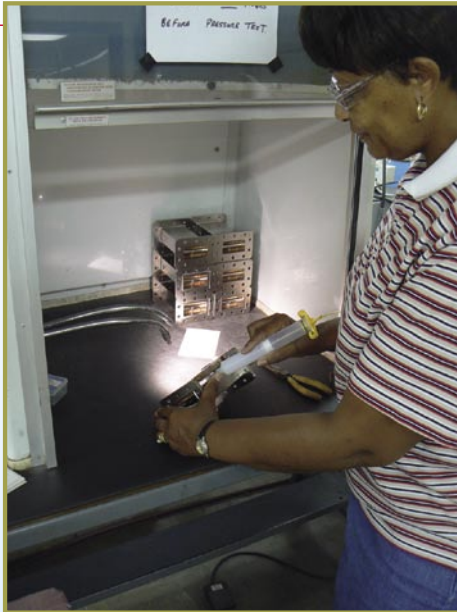
■ La sonda de recepción del filtro es colocada en su sitio por Vertell Brantley. El pegamento usado debe resistir durante tres horas; los filtros se guardan en esta cámara protegida del aire circundante. Después de esto, los filtros se fijan con un recubrimiento para resistir las condiciones atmosféricas.
