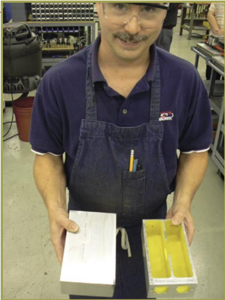
■ Dale Newton nos muestra la sucesión de la producción: Desde un bloque sólido de aluminio (a la izquierda) se fresa toda la caja principal del filtro con todas las aperturas para los conectores y tornillos (a la derecha).
