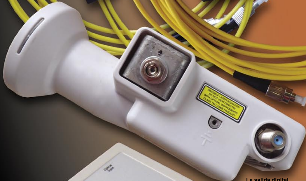
La salida digital óptica y el conector F para la fuente de alimentación
