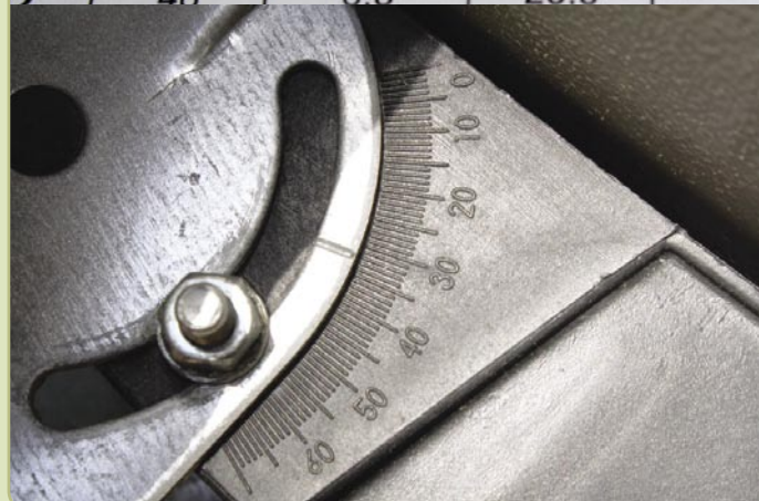
■ (Figura 3) Tabla para la localización de la inclinación de la antena y Escala
