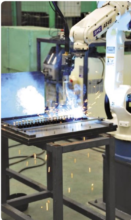
■ Se usan los robots automáticos de soldadura en la producción de las varillas de apoyo.
