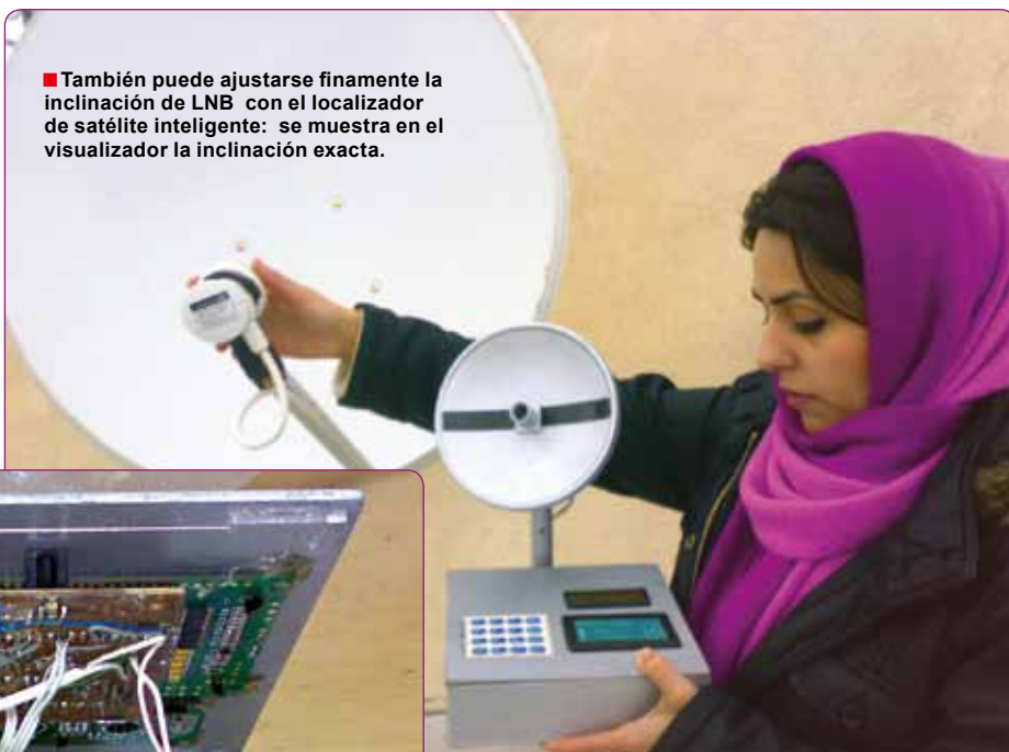
■ Así es cómo se usa el localizador de satélite inteligente se usa: muestra la posición de los satélites que serán recibidos y la antena real se coloca simplemente paralelo a él.
