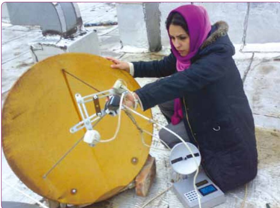
■ Así es cómo se usa el localizador de satélite inteligente se usa: muestra la posición de los satélites que serán recibidos y la antena real se coloca simplemente paralelo a él.
